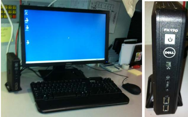
Anzeigestation/MD-Thin-Client-Terminal mit dem Server verbinden. Das Thin-Client-Terminal-Gehäuse, den Bildschirm und die Maus anschließen. Das Thin-Client-Terminal einschalten.
