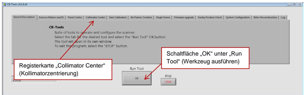
Die „User Instructions“ (Benutzeranweisungen) für diese Kalibrierung befolgen. Beim Durcharbeiten dieser Anweisungen erfordert das Programm das Auslösen der Röntgenstrahlung. Eine Aufforderung wird angezeigt, die Aufnahmetaste zu halten. Zu diesem Zeitpunkt wird die Röntgenstrahlung ausgelöst. Das kann einen Moment dauern. Ein Ton gibt an, wann die Röntgenstrahlung ausgelöst wird, und anschließend erscheinen die „User Instructions“ (Benutzeranweisungen), die Aufnahmetaste loszulassen.
