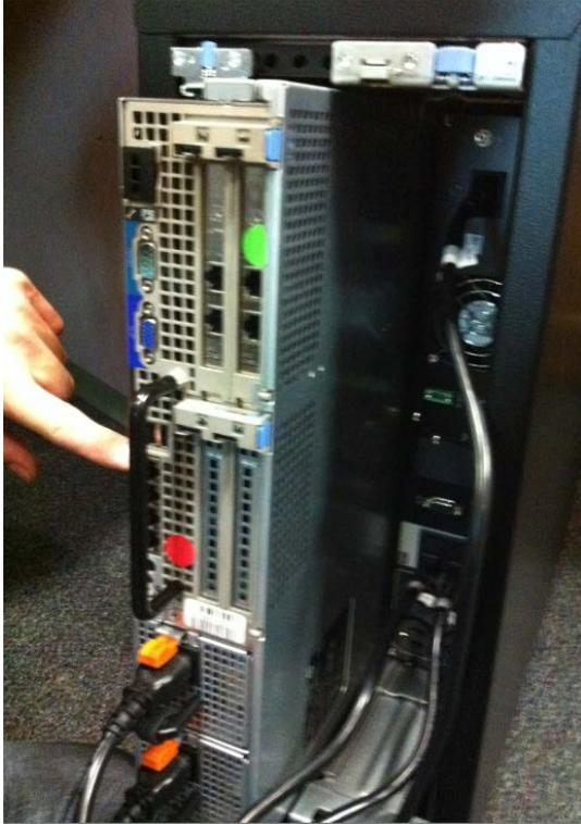
Den Server einschalten und sicherstellen, dass alle VM eingeschaltet sind. Die rechte Seitenabdeckung muss entfernt werden, um Zugang zur Einschalttaste des Servers zu erhalten.
