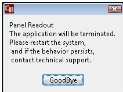
**Kommunikationsfehler zwischen Firmware und Server:** Sollte ein Kommunikationsverlust der Firmware der eingebetteten Steuereinheit auftreten, wird die folgende Fehlermeldung auf dem Bildschirm angezeigt. Ein Kommunikationsverlust kann durch ein beschädigtes, ausgestecktes oder lockeres Kabel der eingebetteten Steuereinheit oder durch Drücken des Notausschalters auftreten. Die Aufnahmesoftware „CB Scanning Device“ wird beendet. Kabel und Notausschalter prüfen und das System neu starten.
