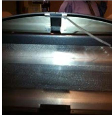
Anschließend können die 4 Versandschrauben entfernt werden. Hierdurch wurde die Gantry während des Versands befestigt.
