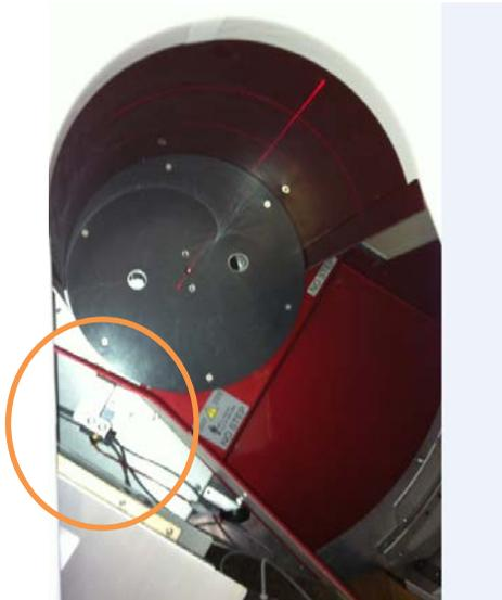
Horizontales Laserlicht: Der untere Laser sollte sich 10 cm über der Plattform befinden. Der obere Laser sollte sich 20 cm über der Plattform befinden. Andernfalls die Einstellschraube am horizontalen Laserlicht-Mechanismus justieren, um die ordnungsgemäße Lage zu erzielen.
