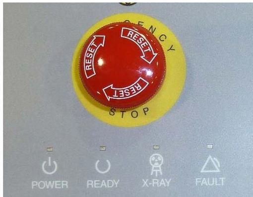
Statusanzeigen an der Anlage: *Abdeckung vorne, links und rechts.*
