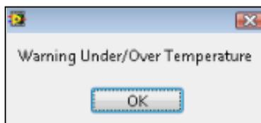
**Startup (Start):** Der Bildschirm „Startup“ (Start) enthält die Anzeige „Internal Temperature“ (Interne Temperatur). Wenn der Bildschirm „Startup“ (Start) und die Temperaturüberwachung feststellen, dass sich die Temperatur außerhalb des Bereichs befindet, wird während der Startsequenz eine Warnmeldung angezeigt.
