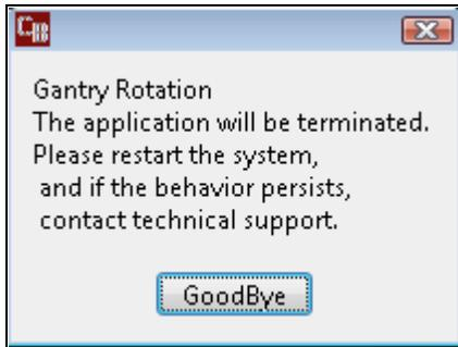
Ein Fehler bei der Gantryrotation *während einer Aufnahme* würde zu einem Kommunikationsfehler zwischen Detektor und Server führen. In diesem Fall würde die folgende Detektor-Lesefehlermeldung angezeigt:
