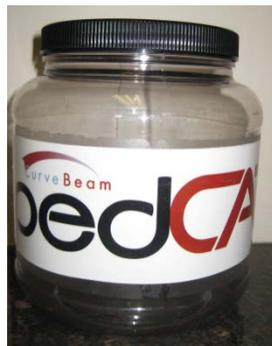
1. Das Wasser-Phantom sollte vollständig mit destilliertem Wasser gefüllt werden; oben einen kleinen Luftraum lassen, damit der Behälter geschlossen werden kann.
