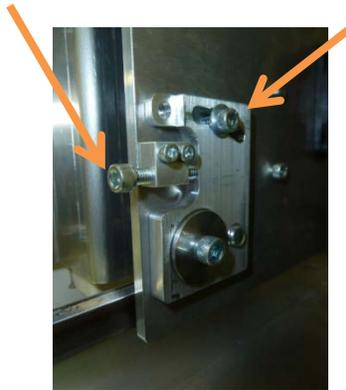
8. Den Röntgenröhrenkopf montieren: Es gibt einen Twist-Lock-Stecker und 4 Schrauben für die Montage.
