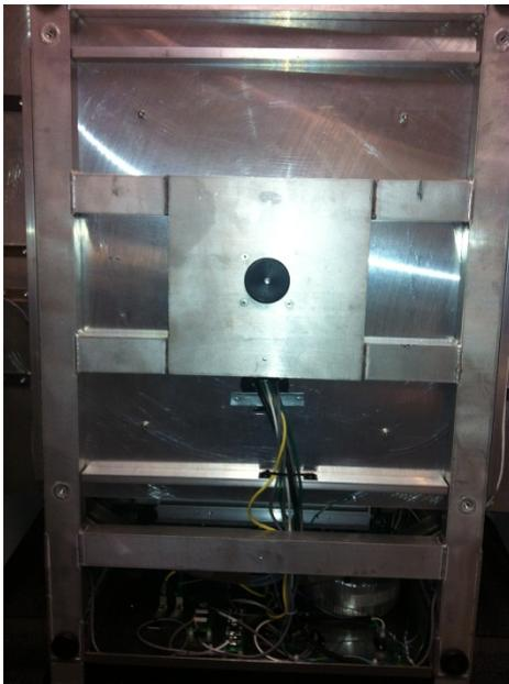
3. Das Netzschaltfeld auf der Rückseite befindet sich in einer „Versandposition“, um es für den Versand festzustellen. Es muss in Betriebsposition gebracht werden. Die oberen 2 Schrauben entfernen. Die übrigen 2 Befestigungsschrauben werden unter dem Schaltfeld aufbewahrt.
